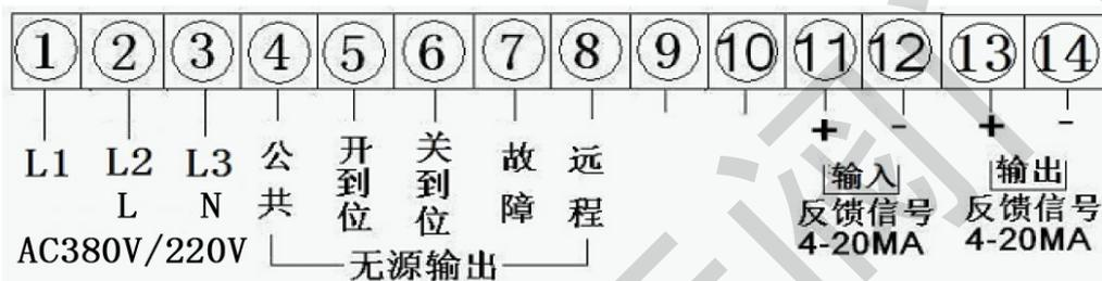
3、ZF一体化开关型接线图（以执行器实际接线为准）
