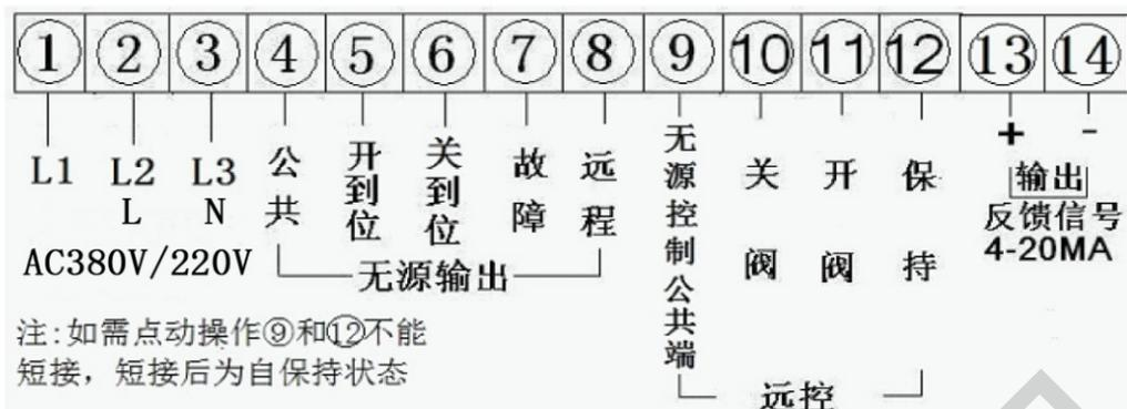
2、ZH一体化调节型接线图（以执行器实际接线为准）
